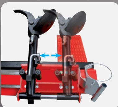
**5** Рабочая консоль перемещается вручную в зависимости от ширины диска и выполняемых работ и фиксируется при помощи специального замка.
