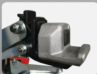
**3** Возможна установка специальных кулачков для работы с легкосплавными дисками (опция)
