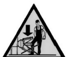
Когда шпиндель опускается с установленным колесом или с раскрытыми захватами, держитесь от него на безопасном расстоянии, чтобы избежать сдавливания.
