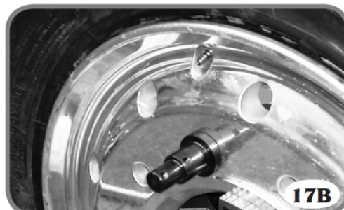
Когда обод проворачивается, стержень упирается в захват, толкая обод и предотвращая его дальнейшее проскальзывание.
