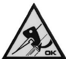
Перед продолжением работы всегда проверяйте, чтобы храповики рычага держателя инструмента были правильно установлены на каретке.
