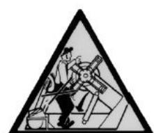
**НИКОГДА** не становитесь между узлом с инструментом и ободом или колесом, установленном на шпинделе.
