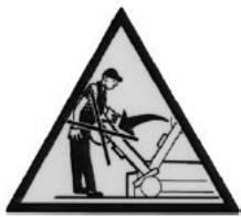
Для предотвращения сдавливания, держитесь на безопасном расстоянии, когда узел с инструментом наклоняется.
