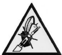
При замене узла с инструментом, во время его установки, уделяйте внимание тому, чтобы предохранить свои руки от сдавливания.
